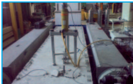
Wrywanie kotwy stalowej z zarysowanego podłoża betonowego
