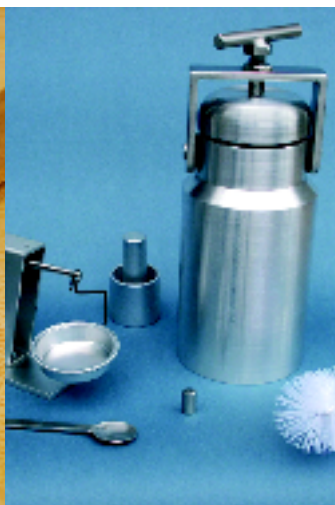
Wilgotnościomierz karbidowy WK-1 do pomiaru wilgotności materiałów budowlanych w zakresie 0% - 10% wilg. wzgl.
