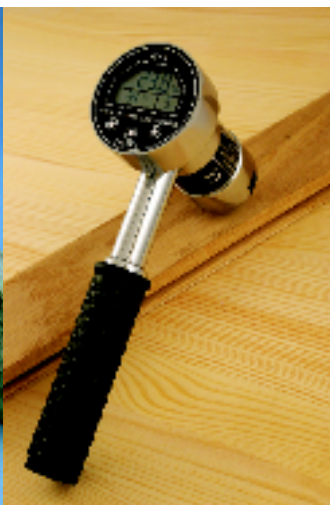
Wilgotnościomierz drewna HIT-3. Zakres pomiarowy: 6% - 60% wilg. bezwzgl.
