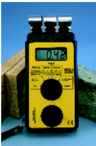
Dwufunkcyjny wilgotnościomierz WIP-24 do pomiaru wilgotności drewna i materiałów budowlanych.
