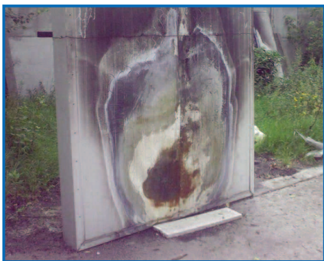
Fot. 2. Panel z okładziną metalową po badaniu
